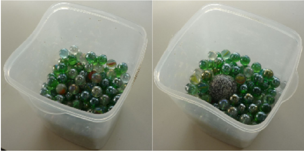
Figura 1.1: Caja con bolitas de diferente tamaño que se hace sacudir para ver el proceso de segregación por tamaño. Tal efecto se conoce como Efecto de las Nueces de Brasil .
